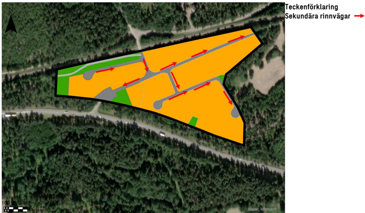
Figur 19. Förslag på sekundära avrinningsvägar vid skyfall, dvs. lågstråk och lutningar i terrängen där stora volymer vatten kan avrinna.
