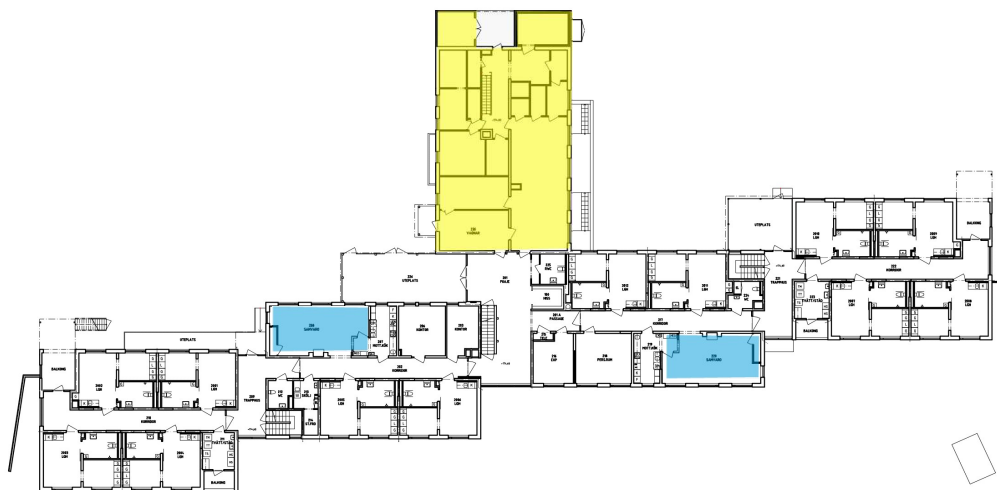
Bild 1 Samvarorum på plan 2 och 3 med eget FTX-aggregat per rum. Gulmarkerad yta i bild är storkök i plan 2 vilket också behandlas av separata fläktar / fläktaggregat.
